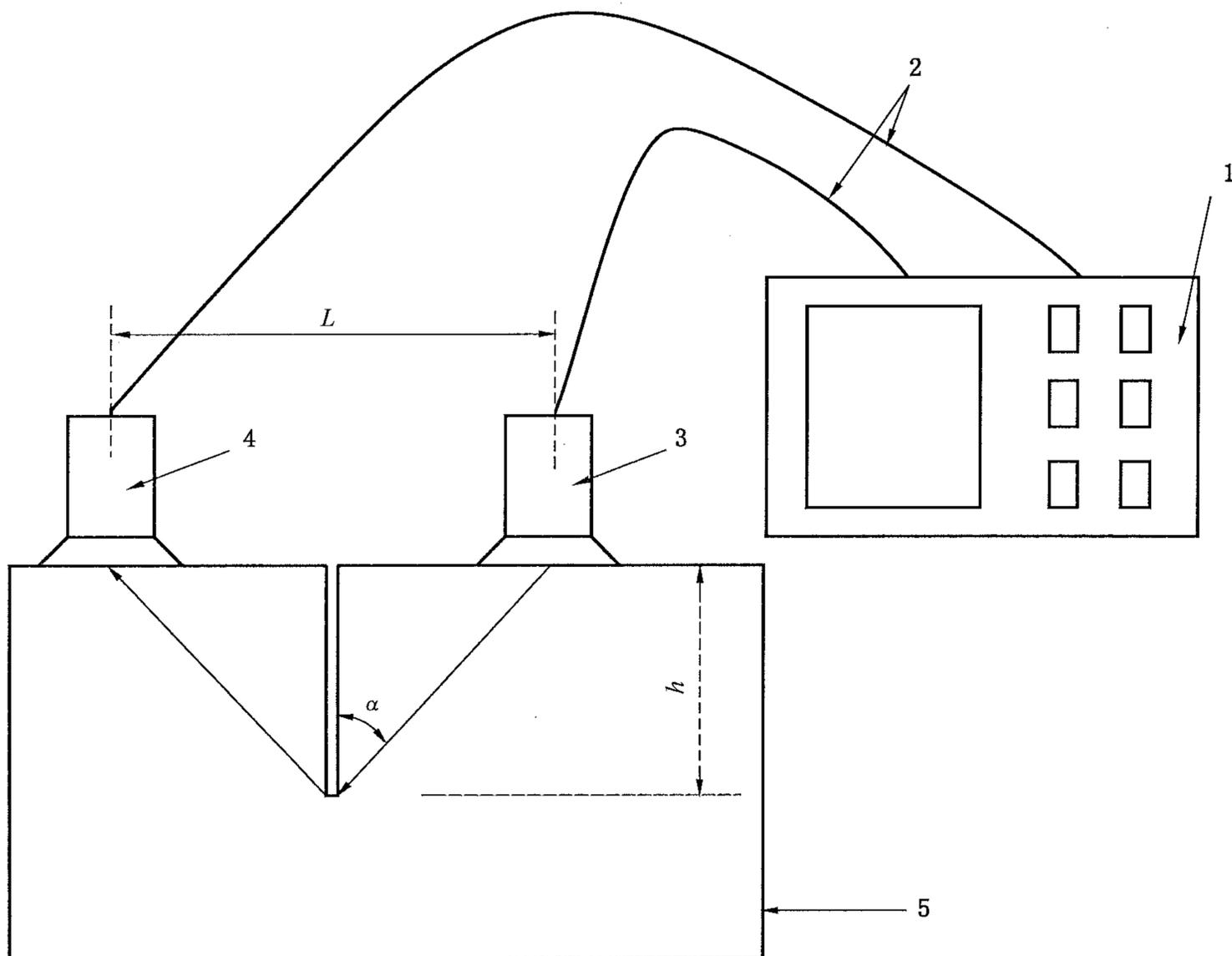
图 2 裂缝深度测量仪工作示意图
