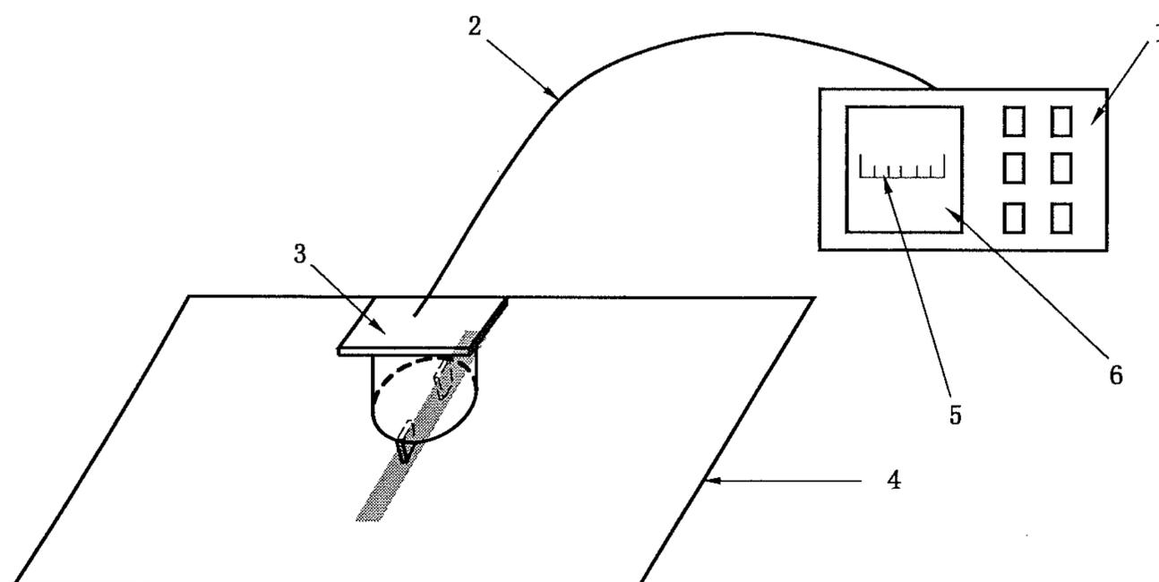
图 1 裂缝宽度测量仪工作示意图
