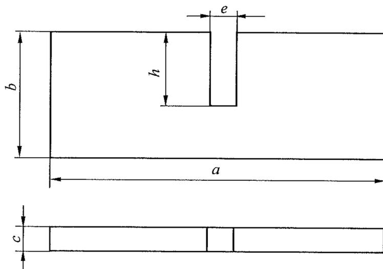
图 C.1 深度标准块尺寸示意图
