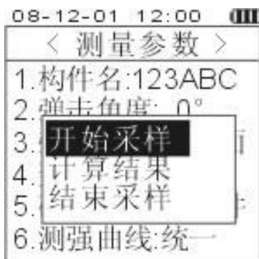
**【计算结果】**：当采集完足够的测区数据并录入测区的碳化深度后，进行构件数据的计算，完成当前构件的测量。
