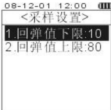
回弹值采样时，若当前回弹值在仪器设定的有效值范围内，则回弹值显示在光标所在位置并更新柱状图，若当前回弹值在仪器设定的有效值范围外，会弹出一个采样错误的提示窗口并且仪器会自动剔除该异常回弹值，当完成当前测区采
