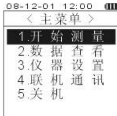
【开始测量】：进入参数设置界面，进行新构件的参数设置并进行采样操作。
