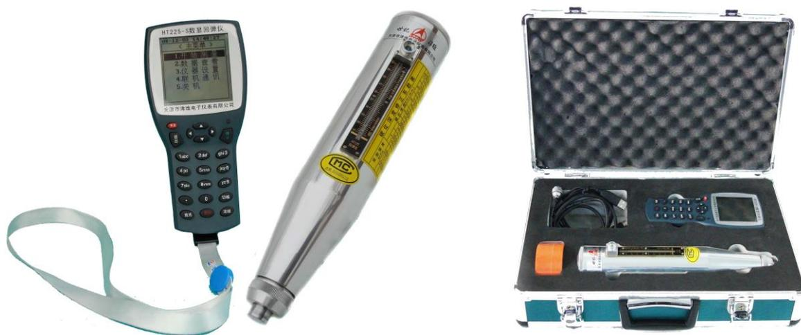
语音数显回弹仪主机接收数字回弹传感器的采样数据并依据技术规程进行数据处理，实时显示混凝土构件采样数据及抗压强度推定值。回弹值可以选择语音形式输出，无需观察屏幕显示即可获得回弹值数据，极大的提高检测人员的测量
